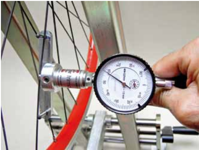
Tensiometro con elenco di calibratura, anche per raggi piatti
