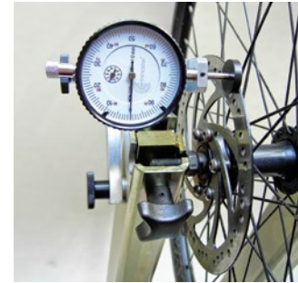
Brems Scheiben-messeinrichtung nur Modell Comfort
